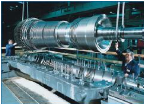
Сл.2.3.19. Поставување на центриран ротор во кукиштето на турбината.
