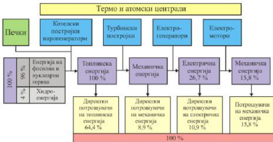
Сл. 2.1.1. Принципиелна шема на трансформација на енергијата во сферата на материјалното производство.
