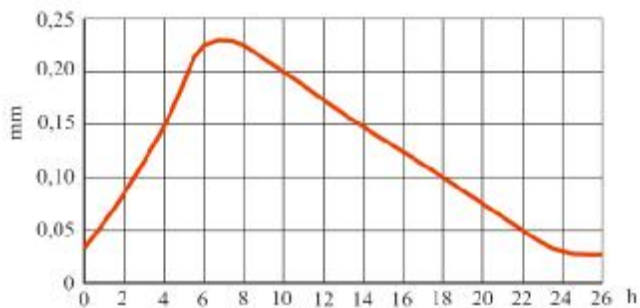
Сл. 2.3.10. Дијаграм на свиткувањето на вратилото во зависност од времето поминато од моментот на запирање.
