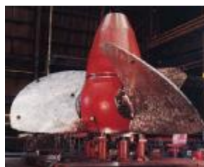
Сл. 3.23. Ремонт на работно коло на Пелтонова и Капланова турбина.
