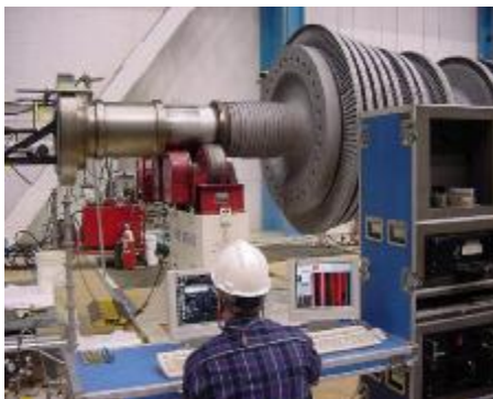
Сл. 2.3.15. Поправка на роторот по методата на релаксација.
