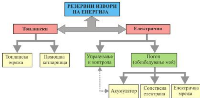
Сл. 4.24. Шематски приказ на резервните извори на енергија кај нуклеарните центри.
