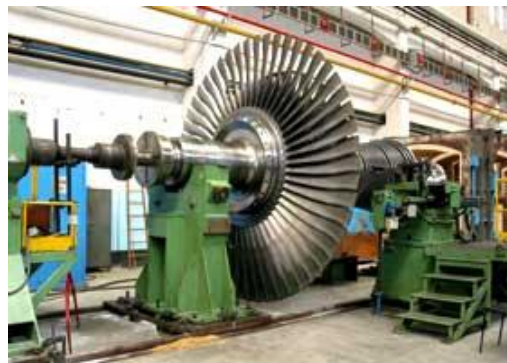
Сл. 2.3.15. Поправка на роторот по методата на релаксација.
