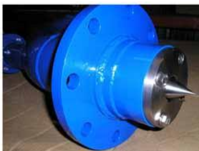
Сл. 3.20 . Регулација на протокот кај Пелтоновите турбини.
