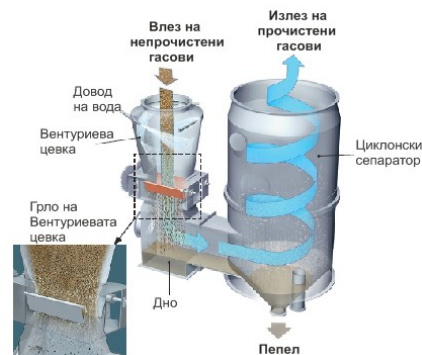
1. Влез на нечисти гасови; 2. Довод на вода; 3. Млазници за распрскување на водата; 4. Конфузор; 5. Грло на Вентуриевата цевка; 6. Дифузор; 7. Циклон-издвојувач на водни капки; 8. Млазници за оросување на циклонот; 9. Излез на пречистените гасови; 10. Одвод на смеса од вода и цврсти честички од pepел;
