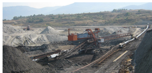
Сл. 7.5 Самооден транспортер со лента за префрлување јаглен
