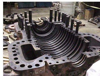
Ремонт на куќиштето на турбината
