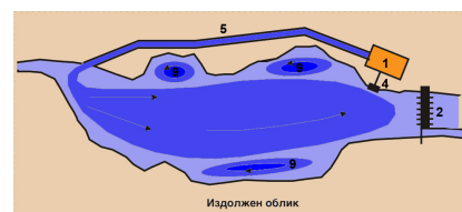
Сл. 5.6.7 Шема на затворен систем за снабдување со разладна вода со акумулација
