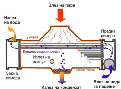
Сл. 5.2.7. Еднооден површински кондензатор
