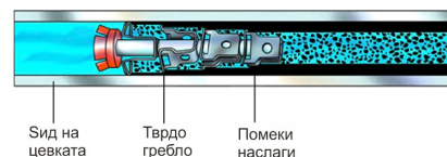
Сл. 10.14. Copco систем за чистење на кондензаторските цевки
