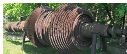
Ротор од парна турбина Parsons 7,5 kW, по 1884 год.
