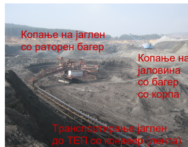
Сл. 7.1 Технолошка шема на стопанисување со јаглен кај една ТЕП
