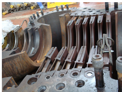
Сл. 5.13. Поставување на дијафрагмите во кукиштето од турбината
