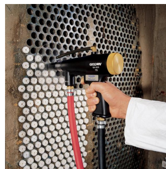
Сл. 10.15. Чистење со сврдла и QS-300 систем од типот на пиштол
