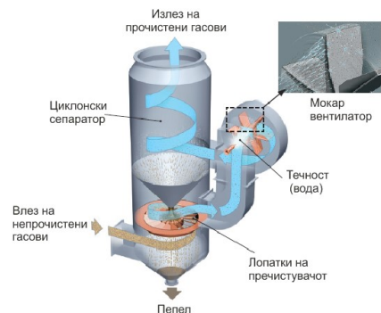
Сл. 9.16. Центрифугален отпепелувач со принудна циркулација (мокар вентилатор)
