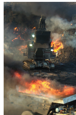
Сл. 7.10 Оксидација на јаглен (самозагревање и самопалење)
