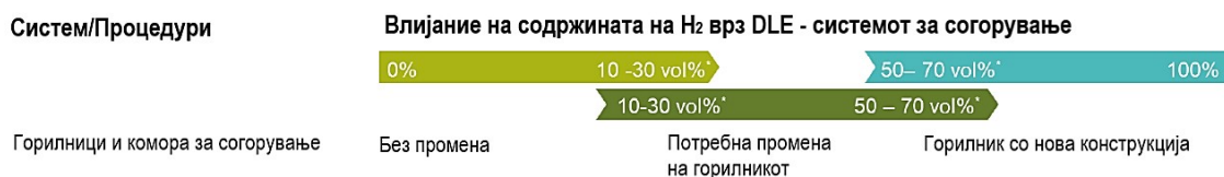
Сл. 4.74. Влијание на содржина на водород во смесата врз DLE системите за согорување
