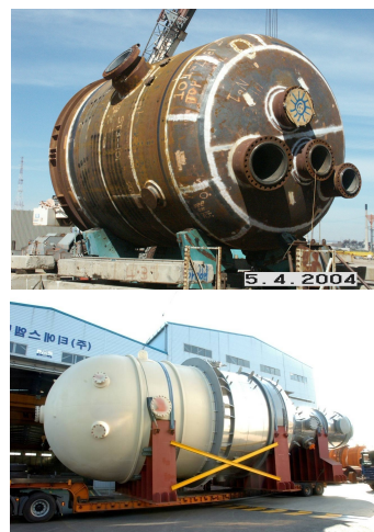
Сл. 5.3.13. Експанзионен сад
