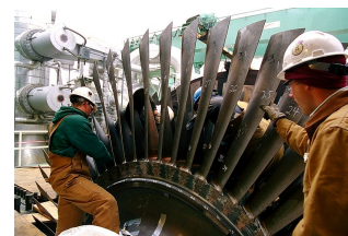
Сл. 5.15. Конструкција на долга лопатка и начин на нејзино прицврстување на роторскиот диск
