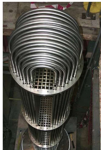
Сл. 8.62. Карактеристична конструкција на генератор на пара модел 54F која се применува кај реакторите ладени со лесна вода од производителот Westinghouse, САД.
