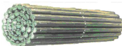
Сл. 10.22. Шематски приказ на каландрија со детал на горивниот елемент кај реакторите Candu
