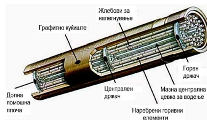
Сл. 8.5. Пресек и поглед на горивните елементи и канали кај AGR реакторите
