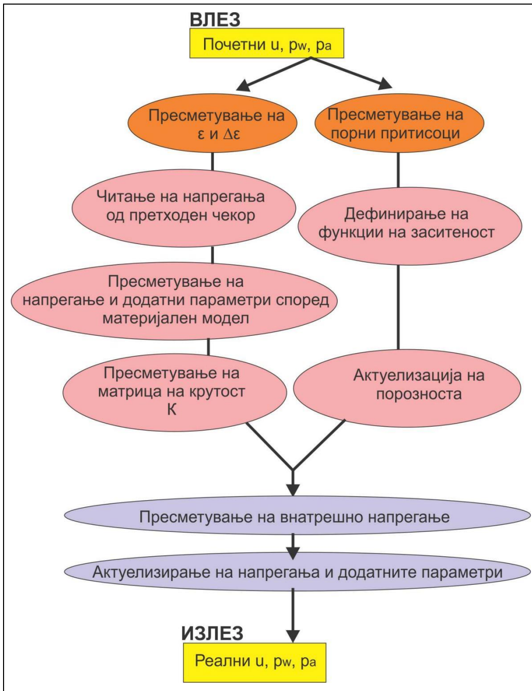
Слика 4.1. Пресметување на променливите во трифазниот почвен модел
