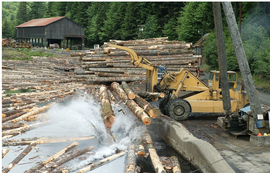
Слика 49. Складирање на суровината во базен со вода
