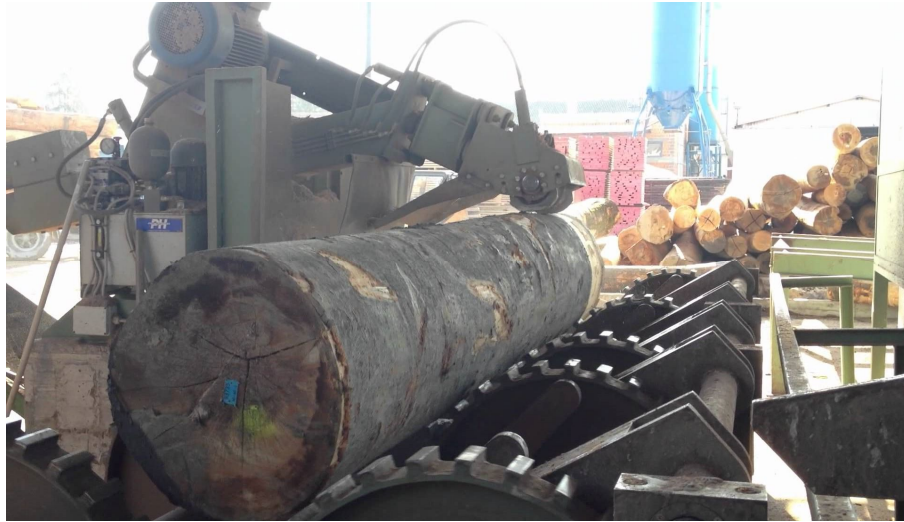
Слика 38. Окорување на трупци со машина за глодање
