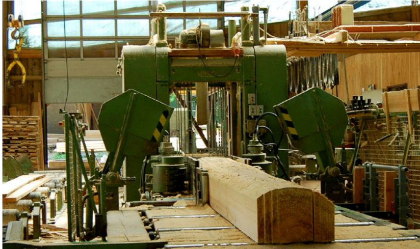
Слика 69. Двократен верикален гатер со современи транспортни уреди
